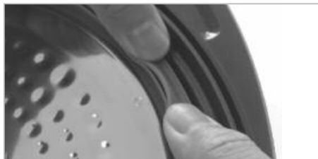
① بعد مطابقة النقاط القياسية من 1 إلى 6، اضغط على بقية الحشوة في الأخدود عن طريق الدفع على حافتها الخارجية.
