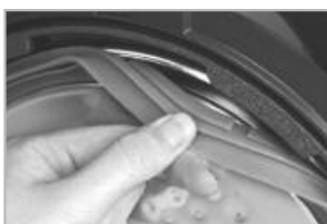
② إزالة الحشوة المضغوطة، أمسكها كما هو موضح في الصورة أعلاه ثم اسحبها للخارج.
